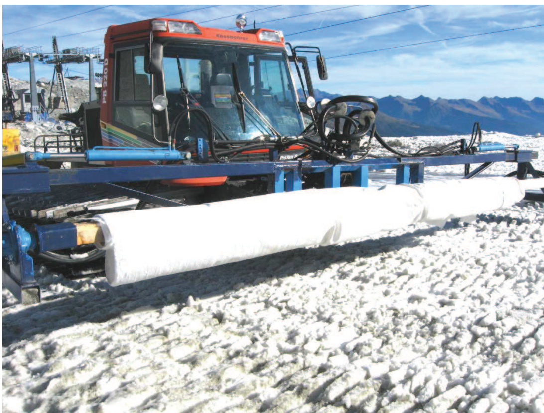
Fig. 4.3: apposito macchinario collegato al gatto delle nevi utilizzato per il riavvolgimento dei teli (foto M. Donati, 23-09-2010).
