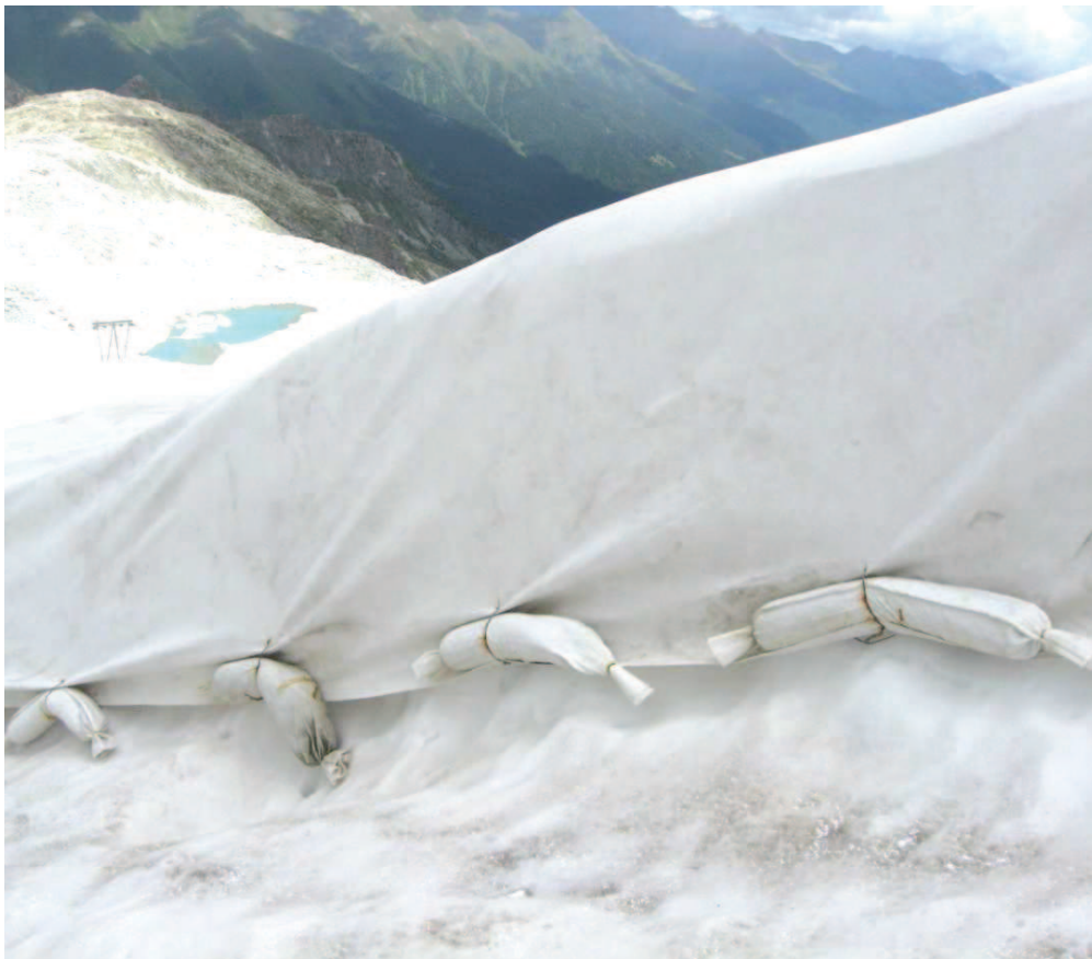
Fig. 4.2.1: risultato ottenuto alla fine della stagione estiva con quasi 2 m di spessore di neve al di sotto della copertura geotessile (foto M. Donati, settembre 2010).
