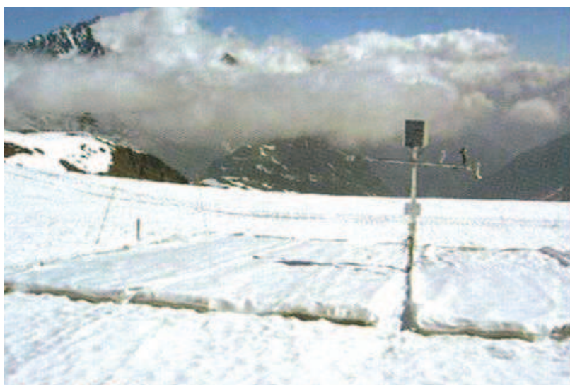
Fig. 3.1: stazione AWS posizionata in una parcella sperimentale sul ghiacciaio austriaco.
