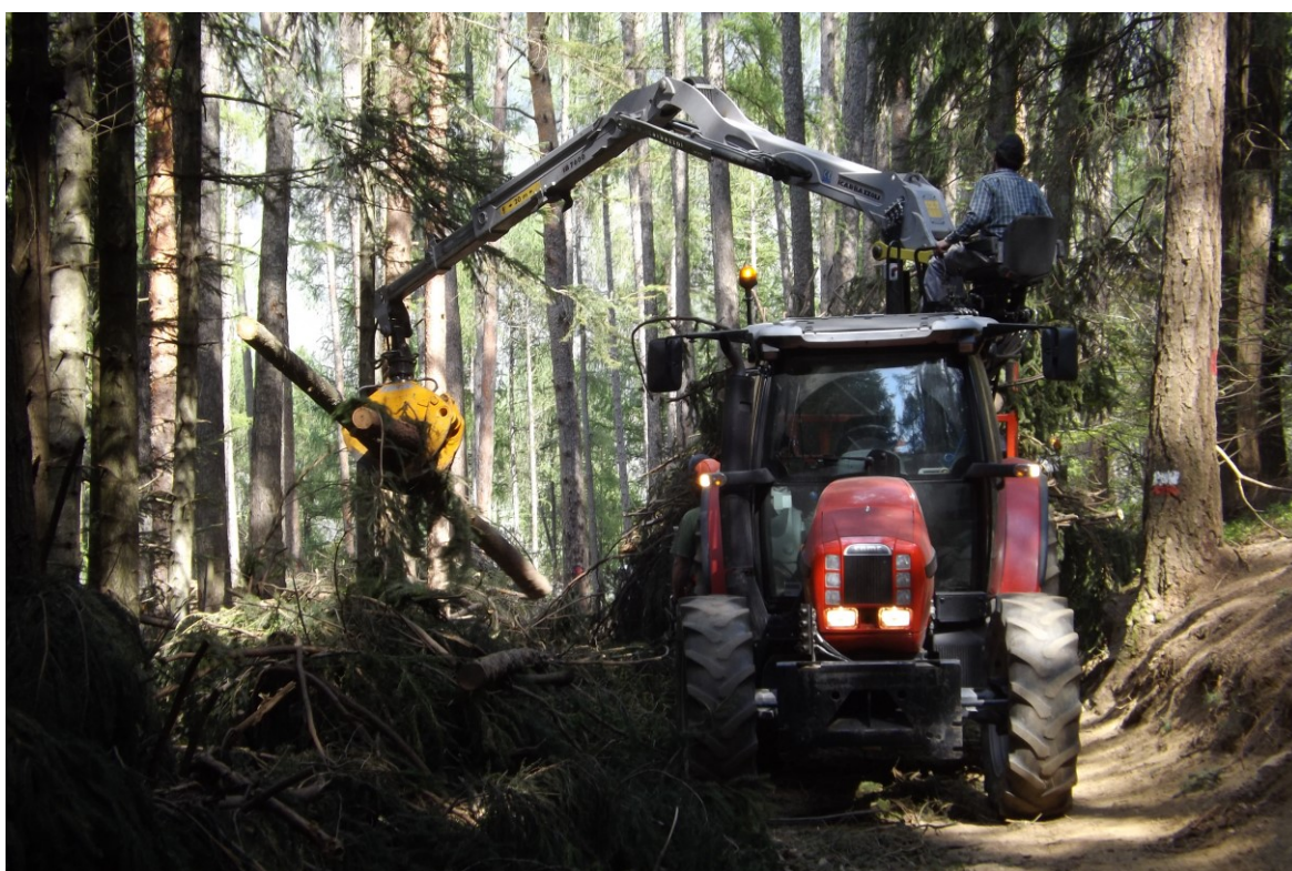
Carro forestale per il carico e scarico dei toni da lavoro
