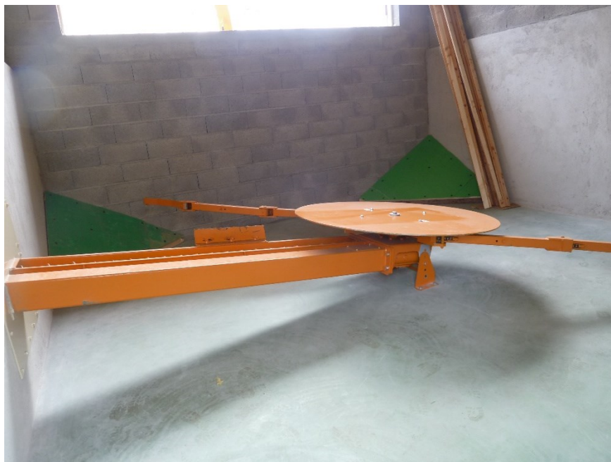
Figura 13: Foto raffigurante l'agitatore meccanico nel deposito di stoccaggio.
