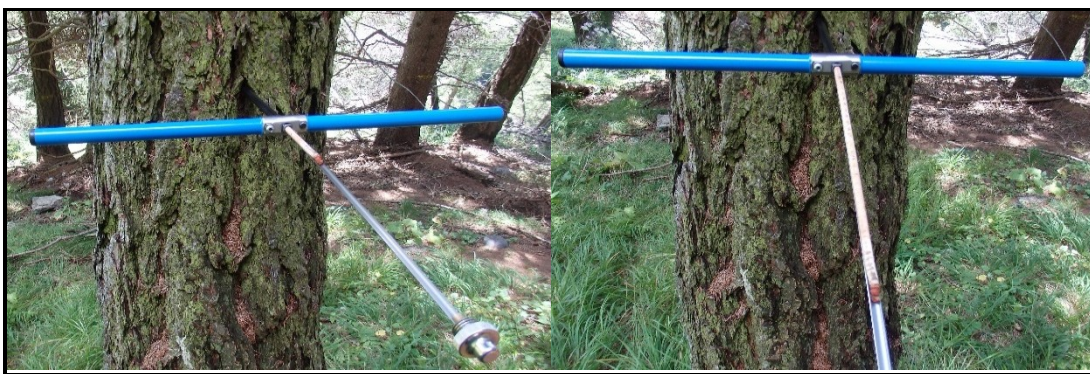
Fig.17: sonda incrementale ed estrazione del campione di legno da Larix decidua
