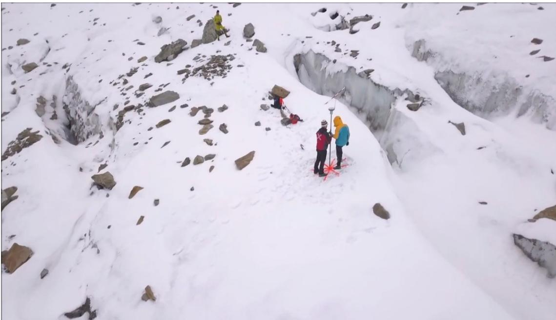
*Figura 29 e 30 - Rilievo delle coordinate topografiche di un marker con l'utilizzo della stazione mobile sul Ghiacciaio della Sforzellina.*
