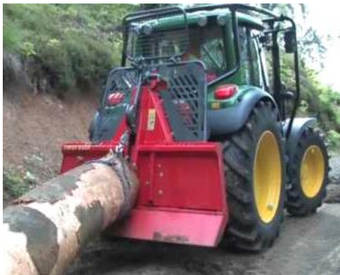
Immagine 1.6.1.3, Da sinistra, verricello idraulico con attacco a 3 punte modello Krpan - 9,5EH, verricello portatile Nardoni, modello Stihl.
