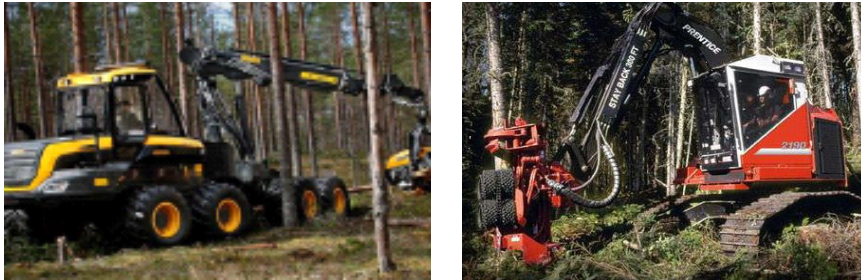
Immagine 1.6.2.4, Da sinistra, macchina abbattitrice-transportatrice di piante con organi di propulsione a ruote gommate, macchina abbattitrice-transportatrice di piante con organi di propulsione a cingoli.
