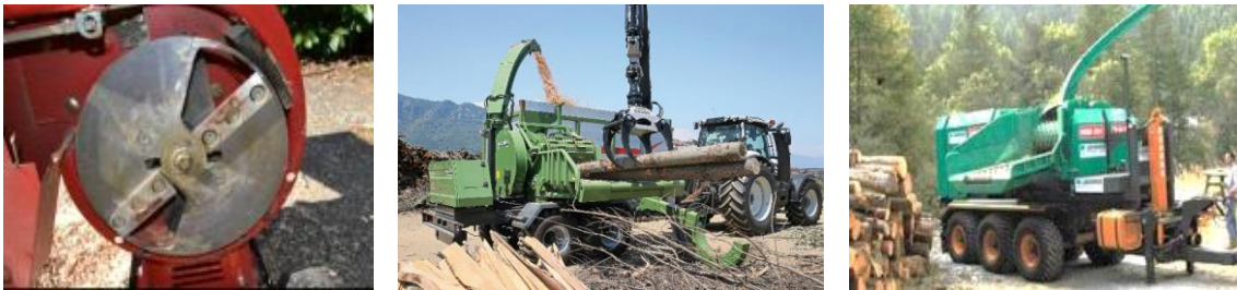
Immagini 1.6.2.6, Da sinistra, interno cippatrice a disco del diametro di 80 c, macchina cippatrice ferma, cippatrice di grande dimensione in funzione collegata alla macchina motrice (trattore).
