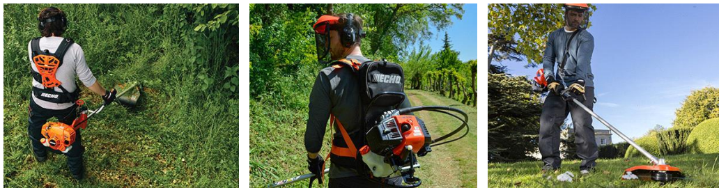
Immagini 1.6.2.8, Decespugliatore in funzione: da sinistra, decespugliatore standard, decespugliatore a zaino e decespugliatore a batteria.
