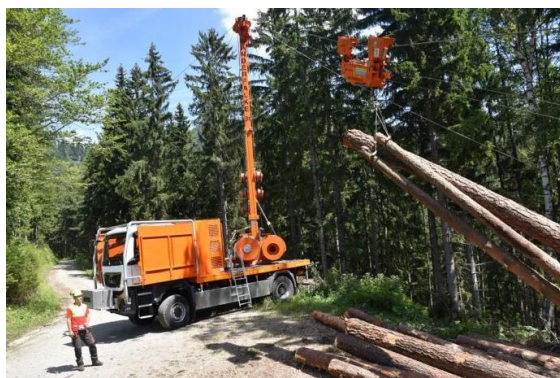
Immagine 1.6.2.2, Gru a cavo montata su rimorchio che funge da torretta nel piazzale di scarico legname della teleferica.
