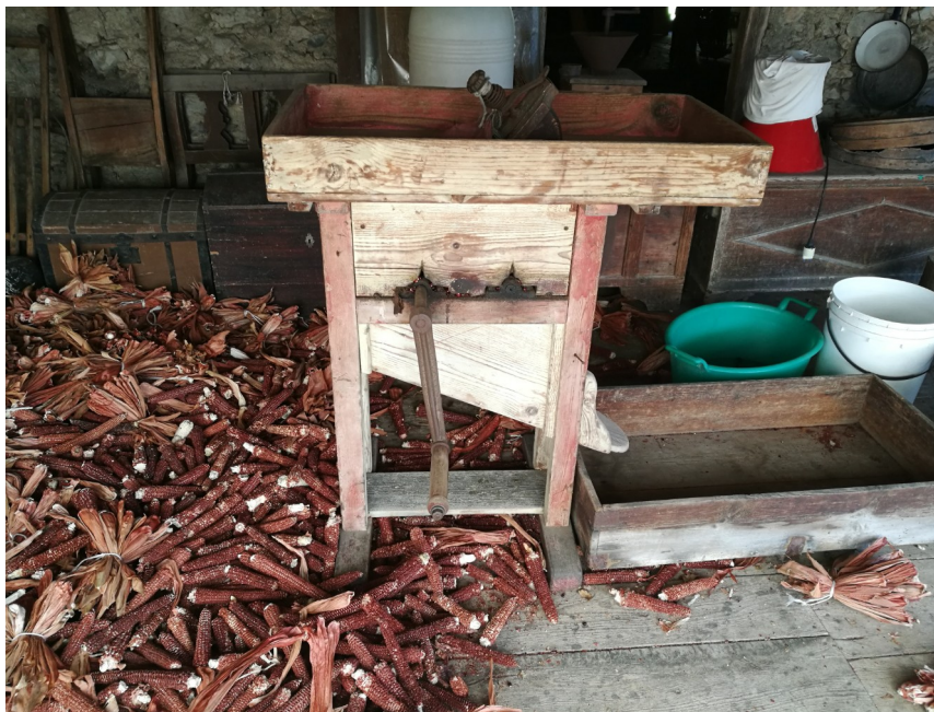
Figura 9- Macchina tradizionale per la sgranatura manuale delle spighe, durante questa fase sono stati misurati i vari campioni
