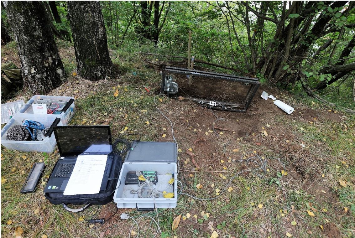
Figura 22 – Postazione per la misurazione delle prove di pull-out
