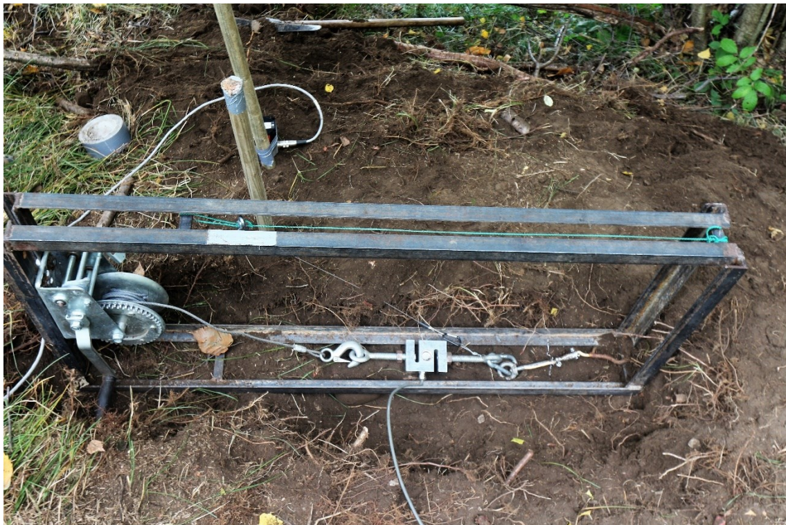
Figura 19 – Macchinario per la trazione pronto alla prova
