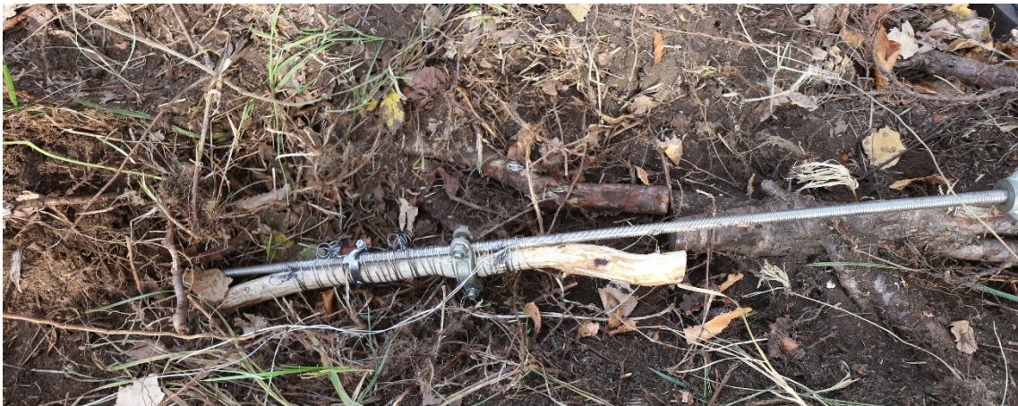
Figura 21 – Fissaggio di una radice di diametro superiore a 20 mm all'asta di ferro
