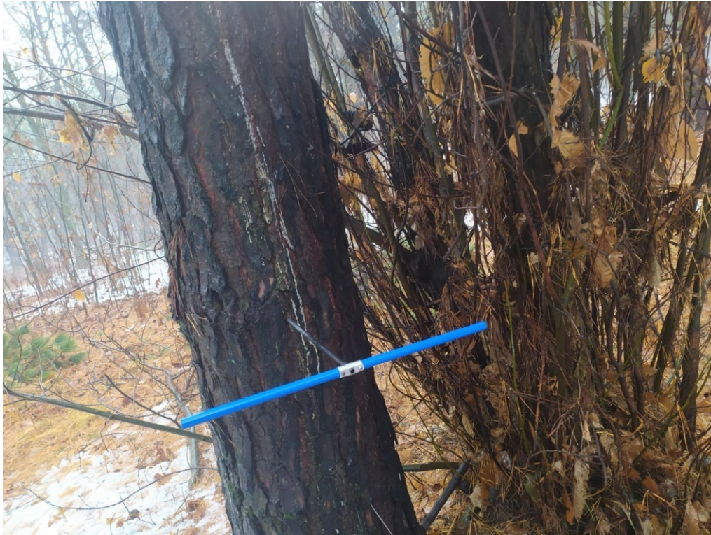
Figura 9: esempio di succhiello di Presler in fase di carotaggio di un pino
