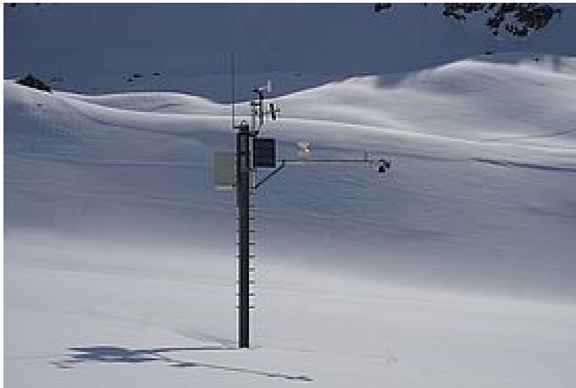
Figura 5.1: esempio di stazione nivometrica
