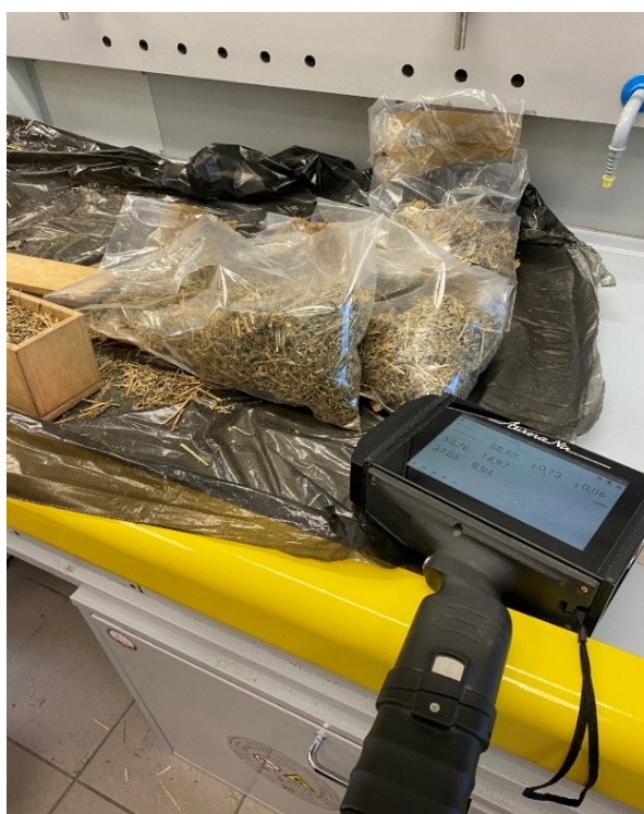
Figura 2- strumento "Aurora NIR", con il quale è stata effettuata l'analisi qualitativa dei foraggi
