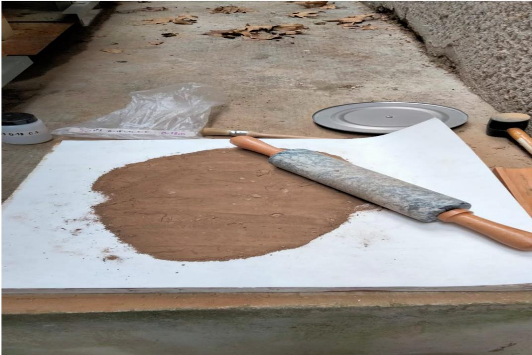
*Figura 2.3.1: Particolare di un campione di suolo in fase preliminare di setacciamento.*
