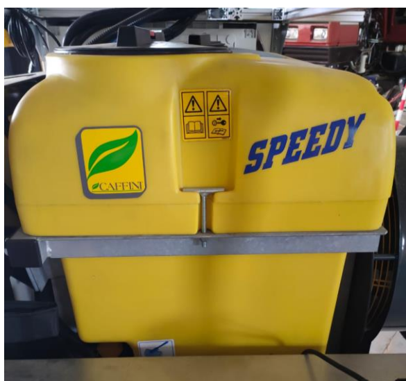
Figura 9: Serbatoio di AgrosenseBot di capienza 300 l
