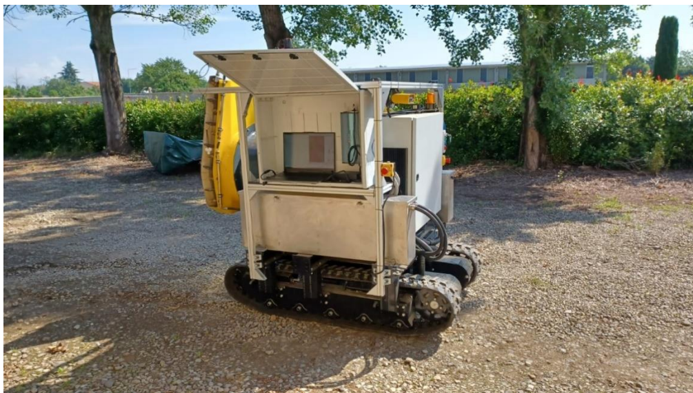
Figura 37: AgroSenseBot durante l'esperimento per la tenuta di carreggiata lungo filare
